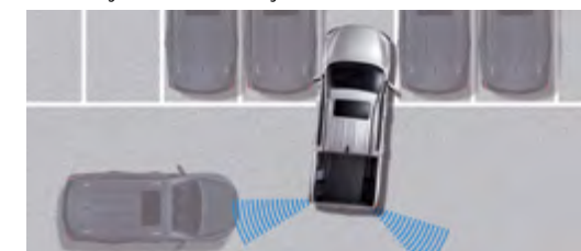
RCTA - system monitorowania ruchu za pojazdem
