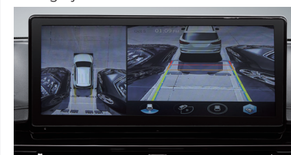
System kamer 360 stopni)
